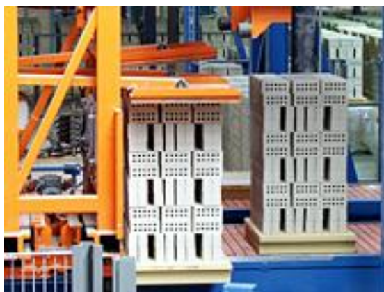
شکل ۱۰- بارگیری آجرها توسط چنگ مکانیکی
