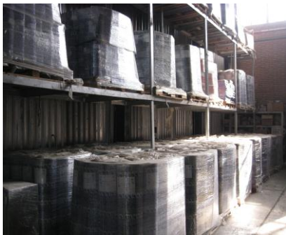
شکل ۱۳- انبارش عایق‌های رطوبتی با پوشش پلی اتیلن و برچسب در کف انبار و در قفسه
