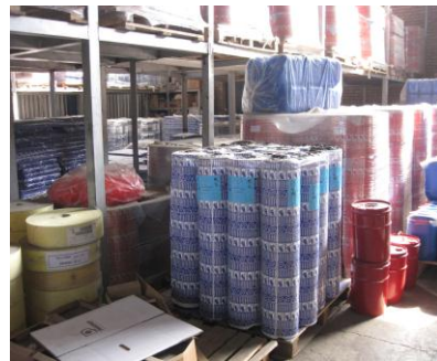
شکل ۱۳- انبارش عایق‌های رطوبتی با پوشش پلی اتیلن و برچسب در کف انبار و در قفسه
