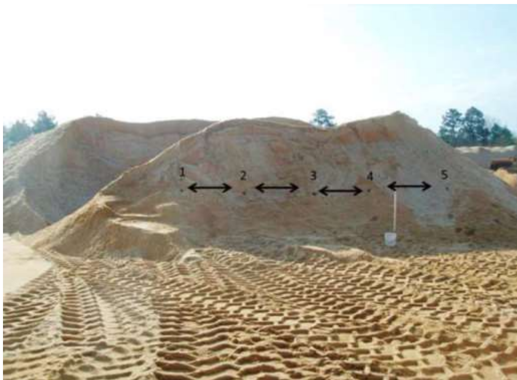
شکل ۴- نمونه‌برداری سنگدانه ریز از دپو با استفاده از لوله نمونه‌برداری
