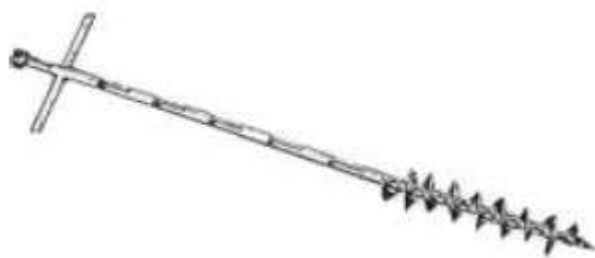
شکل پ-۳، مته نمونه برداری مناسب برای نمونه برداری از کیسه و ظروف
